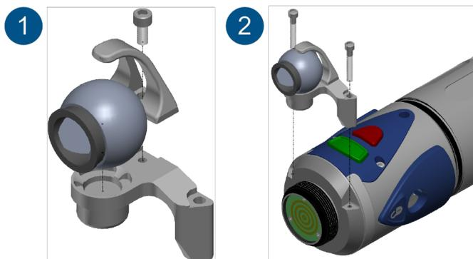
Figure 5-5 FaroArm Edge SMR Bracket
